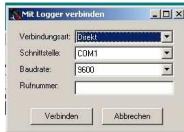
Hier werden die Parameter eingegeben, mit denen DALOSKom das Loggersystem verbinden soll. Im Beispiel ist die Verbindungsart „Direkte Datenleitung“ eingestellt. Dann wird die serielle Schnittstelle, z.B. „COM1“ für diese Verbindung festgelegt. Die Baudrate bleibt für DALOS535-Systeme mit „9600 Baud“ unverändert.
