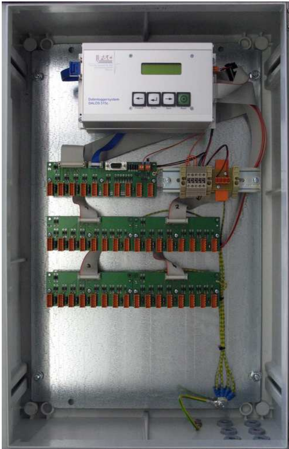
Beispiel 2: Komplette DALOS515-Loggerkonfiguration mit 40 Messkanälen als Messstation für Bodentemperatur- und Feuchtesensoren mit geschalteter Sensorstromversorgung im IP65-Gehäuse 400x600x200
